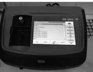
Espectrofotômetro portátil, aparelho de análise de água adquirido pelo Programa Apa para Todos, consegue identificar componentes desconhecidos que estão na água
